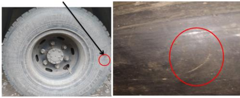
Gambar 5 Penampakan Baret Ban Pada Jarak Tempuh 15.000 km sumber : Penelitian mandiri 2023
