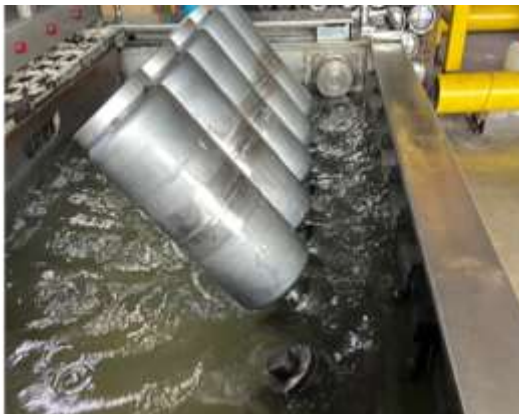
Gambar 2 Proses Uji Tekanan
