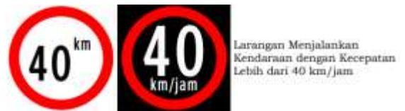
Gambar 3.2 Rambu Larangan Batasan Kecepatan
