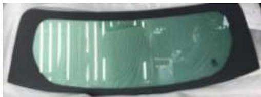
Gambar 3 Material kaca dengan thicknes 3,1 mm ± 0,1mm
