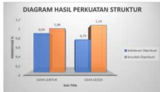
Gambar 3.7 Persentase Kenaikan Perkuatan Struktur menggunakan CFRP
