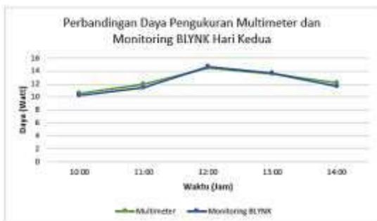
Gambar 20 Grafik Perbandingan Daya Pengukuran Multimeter dan Monitoring BLYNK Hari Kedua
