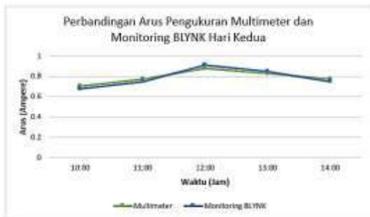
Gambar 19. Grafik Perbandingan Arus Pengukuran Multimeter dan Monitoring BLYNK Hari Kedua
