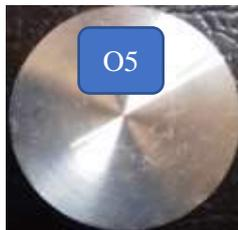
Gambar. 3 Spesimen hasil bubut pada speed 1200 Rpm dengan media pendingin Dromus.
