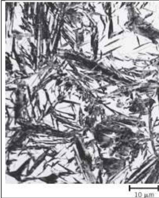
Gambar 5: Struktur Mikro Martensite
