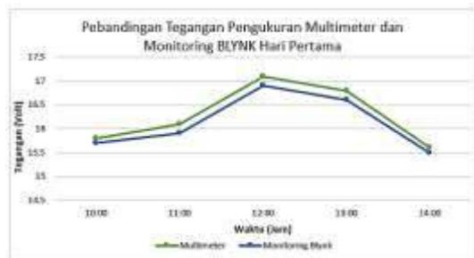
Gambar 15. Grafik Perbandingan Tegangan Pengukuran Hari Pertama
