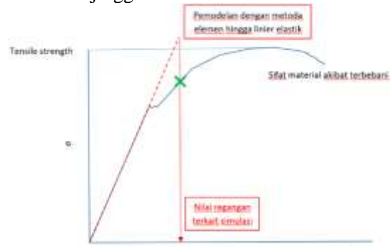
Gambar 14 Pemodelan elemen hingga linier elastis terhadap aktual tegangan di struktur Sumber: Hasil Olah Data
