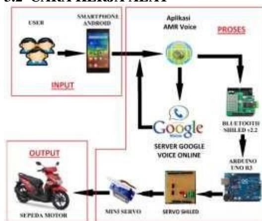
Gambar 9 Alur Kerja Alat Sumber: Hasil Penelitian
