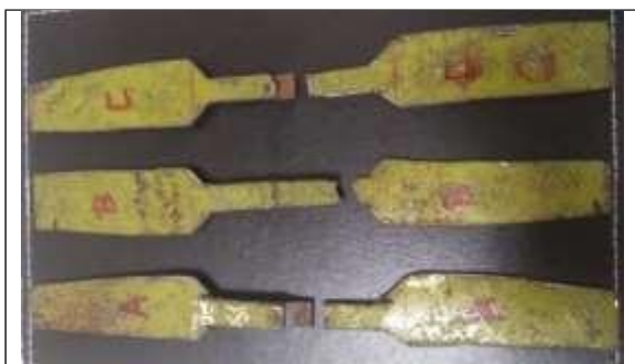
Gambar 4 Profil Patahan Uji Tarik (Sumber: Hasil Penelitian)
