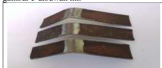
Gambar 5 Profil Hasil Uji Tekuk (Sumber: Hasil Penelitian)
