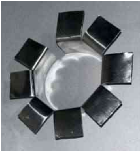
Gambar 9. Hasil Pembentukan Melingkar pada Plat Aluminium Sumber:Penelitian mandiri
