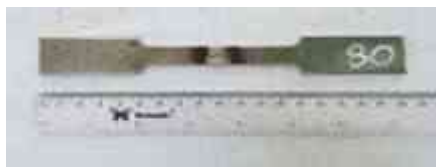
Gambar 10 specimen Uji tarik pengelasan 80 Ampere Sumber: Penelitian Mandiri 2026
