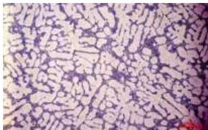
Gambar 2 Struktur Mikro Aluminium AC4CH setelah Solution Treatment dan Quenching pada
