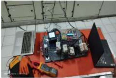
Gambar 5 Pengujian Alat dengan Menggunakan kWh IoT dan Alat ukur Standar. Sumber : Penelitian Mandiri 2025
