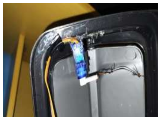
Gambar 6. Sensor Ultrasonik (HC-SR04) yang berada di luar tempat sampah
