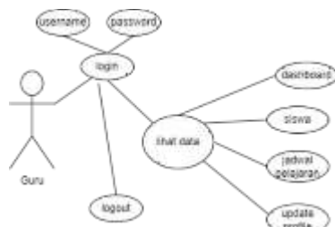
Gambar 4 Use Case Diagram Guru Sumber : Penelitian Mandiri 2024 Use Case Diagram Guru memiliki aktor utama yang dilambangkan dengan simbol orang dengan label Guru dibawahnya. Gambar 4 menggambarkan aktifitas yang dapat dilakukan oleh guru, yaitu :
