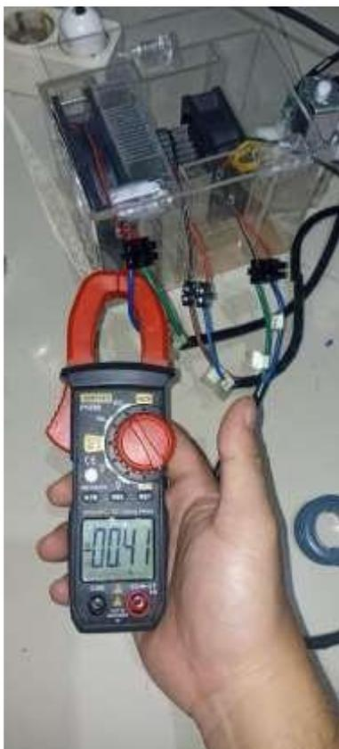
Gambar 5. Pengukuran konsumsi daya perangkat
