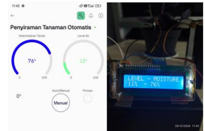
Gambar 14. Pembacaan Kelembapan Tanah Pada Aplikasi Blynk Dan Layar LCD Saat Kondisi Basah
