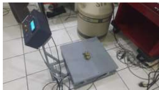
Gambar 4. Proses Pengujian Sensor Load Cell Sumber Data : Hasil Olahan Data Penelitian
