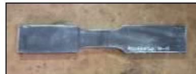
Gambar 4 Sampel Uji Tarik Bagian Logam Induk
