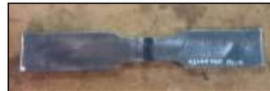
Gambar 3 Sampel Uji Tarik Bagian lasan
