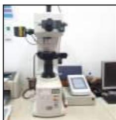
Gambar 8 Peralatan Vickers Hardness (Mitutoyo)
