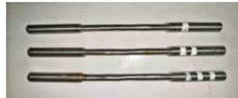
Gambar 8. Spesimen uji tarik 100 A
