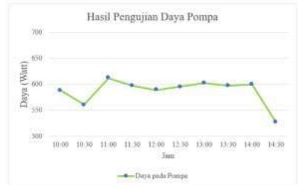
Gambar 12. Grafik Hasil Pengujian Daya pada Pompa.
