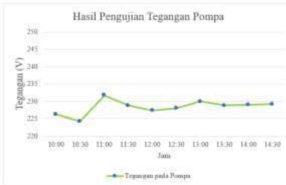
Gambar 10. Grafik Hasil Pengujian Tegangan pada Pompa.
