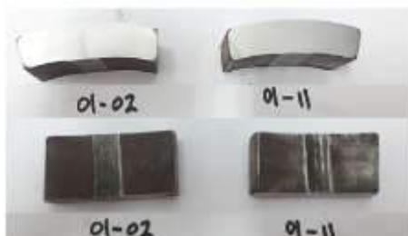
Gambar 6 Sampel uji Metalografi (atas) dan Uji Hardness (bawah).
