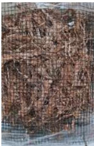
Gambar 5. Filter Limbah Cangkang Telur Dan Ijuk Serat Batang Kelapa
