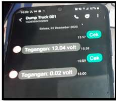
Gambar 7 Tegangan Baterai Ketika Drop Voltage
