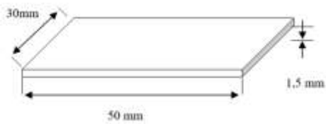
Gambar 2 Ukuran Spesimen Uji
