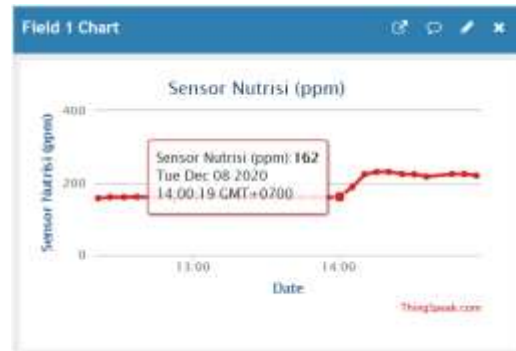
Gambar 11. data sensor nutrisi alat prototipe di webserver thingspeak nilai kepekatan nutrisi dibawah 200ppm
