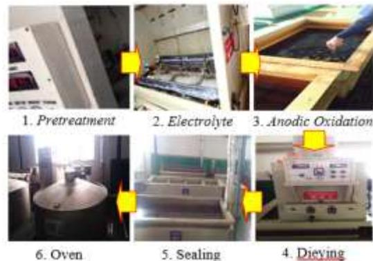
Gambar 1 Tahapan Proses *Anodizing* Yang Dilakukan
