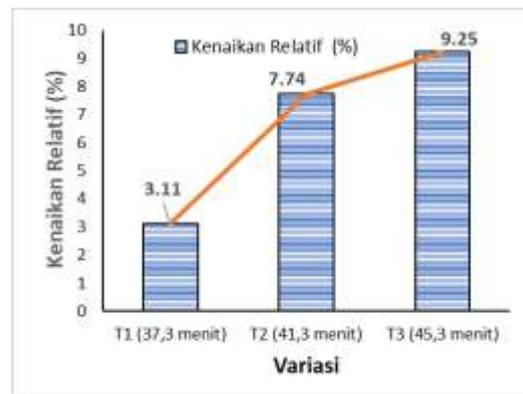
Gambar 9 Grafik hubungan waktu *anodizing* terhadap % kenaikan nilai kekerasan terhadap sampel tanpa *anodizing*
