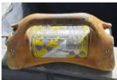
Gambar 8. Kamera Radiografi Gamma Ray (Sumber : Dokumen pribadi)
