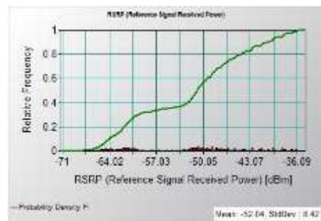
Gambar 3.9 Grafik RSRP lantai 19, dengan nilai CDF dan PDF Sumber Data : Hasil Olahan Data Penelitian
