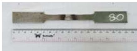
Gambar 10 specimen Uji tarik pengelasan 80 Ampere Sumber: Penelitian Mandiri 2026
