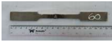
Gambar 9 specimen Uji tarik pengelasan 60 Ampere Sumber: Penelitian Mandiri 2026
