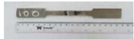
Gambar 4.7 specimen Uji tarik pengelasan 100 Ampere Sumber: Penelitian Mandiri 2026
