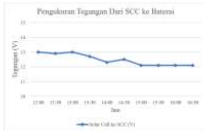
Gambar 8 Grafik Hasil Pengukuran Tegangan dari SCC ke Baterai. Sumber : Penelitian Mandiri 2026
