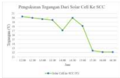
Gambar 7 Grafik Hasil Pengukuran Tegangan dari Solar Cell ke SCC. Sumber : Penelitian Mandiri 2026
