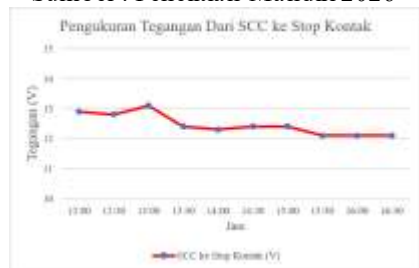
Gambar 9 Grafik Hasil Pengukuran Tegangan dari SCC ke Inverter. Sumber : Penelitian Mandiri 2026
