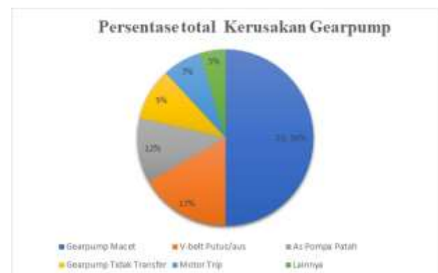
Gambar 6. Data total kerusakan Gearpump Sumber : Penelitian mandiri
