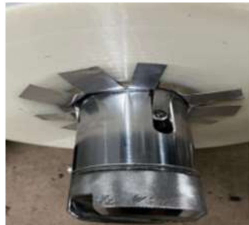
Gambar 14. Sesudah Pemasangan Pengunci Roll Alternatif Sumber: Penelitian mandiri
