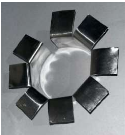
Gambar 9. Hasil Pembentukan Melingkar pada Plat Aluminium Sumber:Penelitian mandiri
