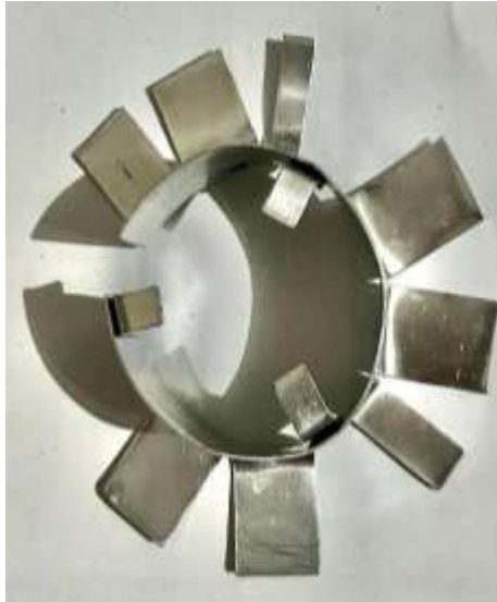
Gambar 12. Pengunci Roll Alternatif Sumber: Penelitian mandiri
