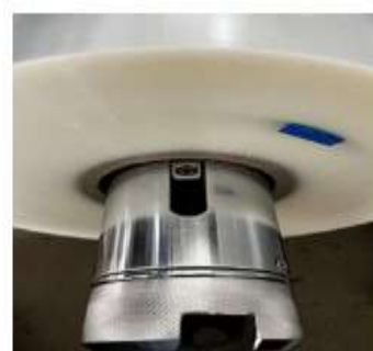
Gambar 6. Sistem pengunci tidak berfungsi Sumber:Penelitian mandiri
