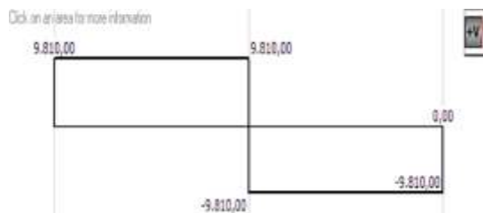
Gambar 10. Diagram Gerak Geser Pembebanan
