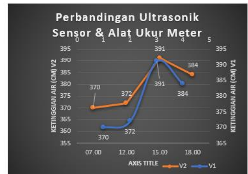
Gambar 20 Grafik Perbandingan II Ultrasonik Sensor dan Alat Ukur Meter
