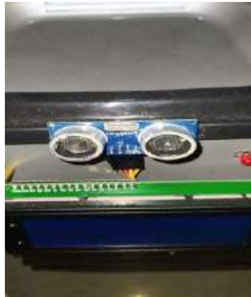
Gambar 6. Sensor Ultrasonik (HC-SR04) yang berada di luar tempat sampah
