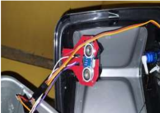
Gambar 7. Sensor ultrasonic HC-SR04 yang berada di dalam penutup sampah
