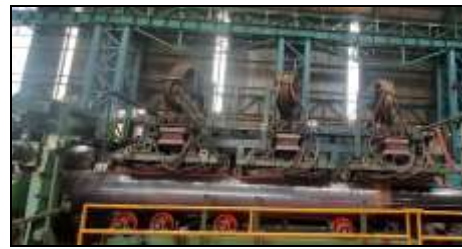
Gambar 2 Proses Annealing Pipa Insitu Pada Line Production
