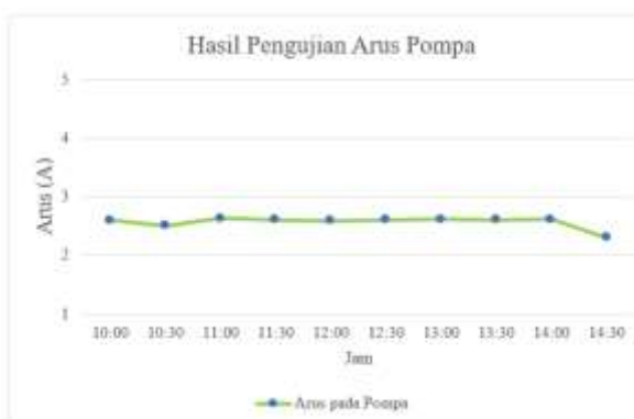
Gambar 11. Grafik Hasil Pengujian Arus pada Pompa. Sumber: Hasil Olahan Data Penelitian
