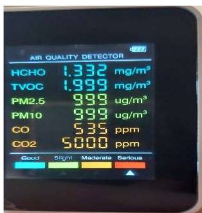
Gambar 6. Hasil Pengujian Filter Limbah Cangkang Telur Dan Ijuk Serat Batang Kelapa Dalam Keadaan Udara Kotor Sumber Data : Hasil Olahan Data Penelitian
