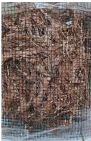
Gambar 5. Filter Limbah Cangkang Telur Dan Ijuk Serat Batang Kelapa Sumber Data : Hasil Olahan Data Penelitian
