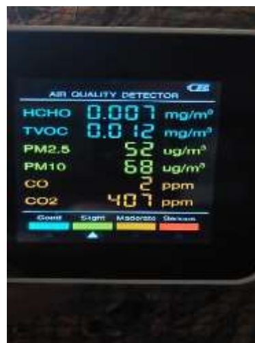
Gambar 7. Hasil Pengujian Filter Limbah Cangkang Telur Dan Ijuk Serat Batang Kelapa Dalam Waktu 10 Menit Sumber Data : Hasil Olahan Data Penelitian
