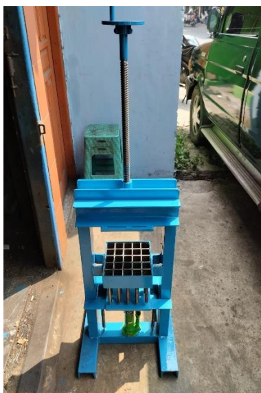
Gambar 3. Hasil Perakitan Alat Press Briket Sumber : Hasil Olah Penelitian
