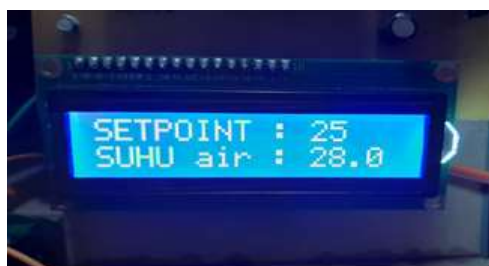
Gambar 13. Tampilan Display Saat Pengaturan Suhu Air
