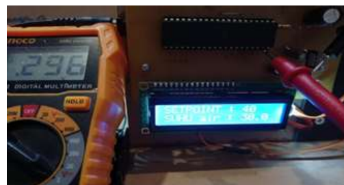
Gambar 8. Tampilan Suhu Sensor Pada Display LCD Dan Tegangan Sensor
