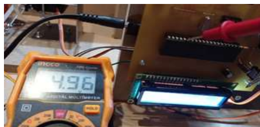
Gambar 10. Pengukuran Tegangan Pin Mikrokontroler ATmega8535
