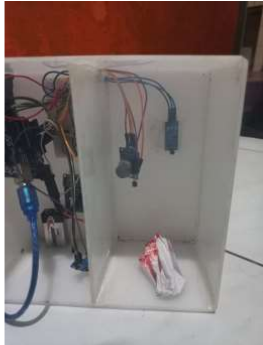
Gambar 10. Pengujian Sensor Asap Sumber : Penelitian Mandiri
