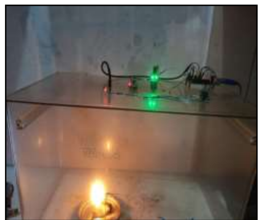
Gambar 4 Pengujian Sessor Suhu DS18D20
