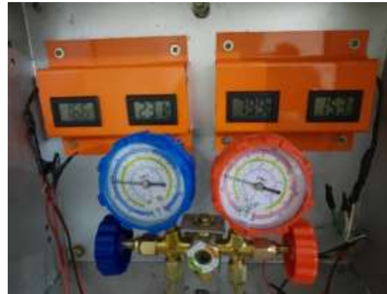
Gambar 4 . Pressure Gauge dan Thermometer Sumber : Hasil Penelitian
