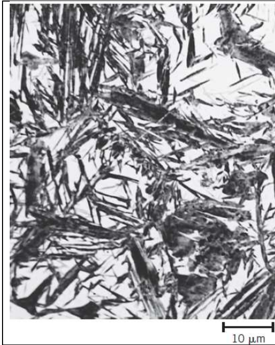
Gambar 5: Struktur Mikro Martensite Sumber: (Callister, Jr., Retwisch, 2012)
