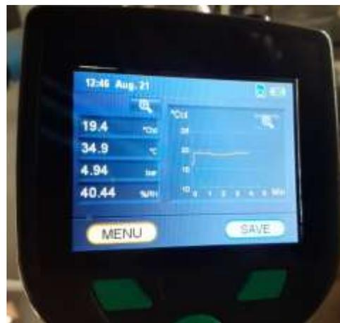
Gambar 7. Proses Pengukuran di Saluran Keluar Mesin Pengering Udara
