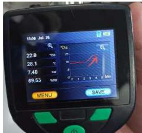
Gambar 6. Proses Pengukuran di Saluran Masuk Mesin Pengering Udara
