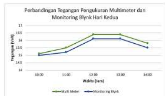
Gambar 18. Grafik Perbandingan Tegangan Pengukuran Hari Kedua Sumber Data : Hasil Olahan Data Penelitian
