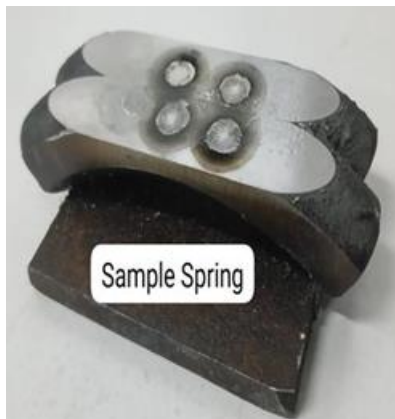
Gambar 5. Material Coil Spring yang sudah dianalisis dengan Optical Emission Spectrometer. Sumber : Penelitian Mandiri 2024
