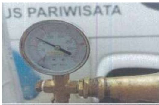
Gambar 2 Pengujian tekanan titik terjauh Sumber: Hasil Olahan Data Penelitian
