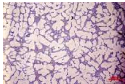
Gambar 3 Struktur Mikro Aluminium AC4CH setelah Solution Treatment 480°C dan Artificial Aging 150°C, pembesaran 100× Sumber: Hasil Penelitian
