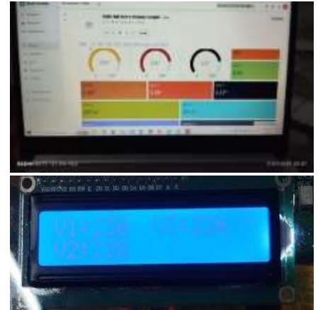
Gambar 6 Tampilan Tegangan Listrik pada Aplikasi Blynk dan Pada LCD Alat dan Alat Ukur Konvensional.
