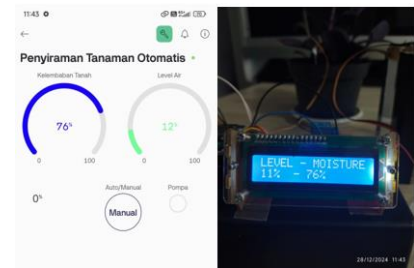
Gambar 14. Pembacaan Kelembaban Tanah Pada Aplikasi Blynk Dan Layar LCD Saat Kondisi Basah
