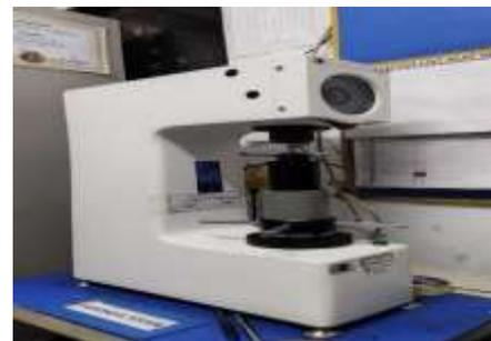
Gambar 13. Mesin uji kekerasan rockwell type FR-1AN
