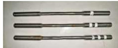
Gambar 8. Spesimen uji tarik 100 A
